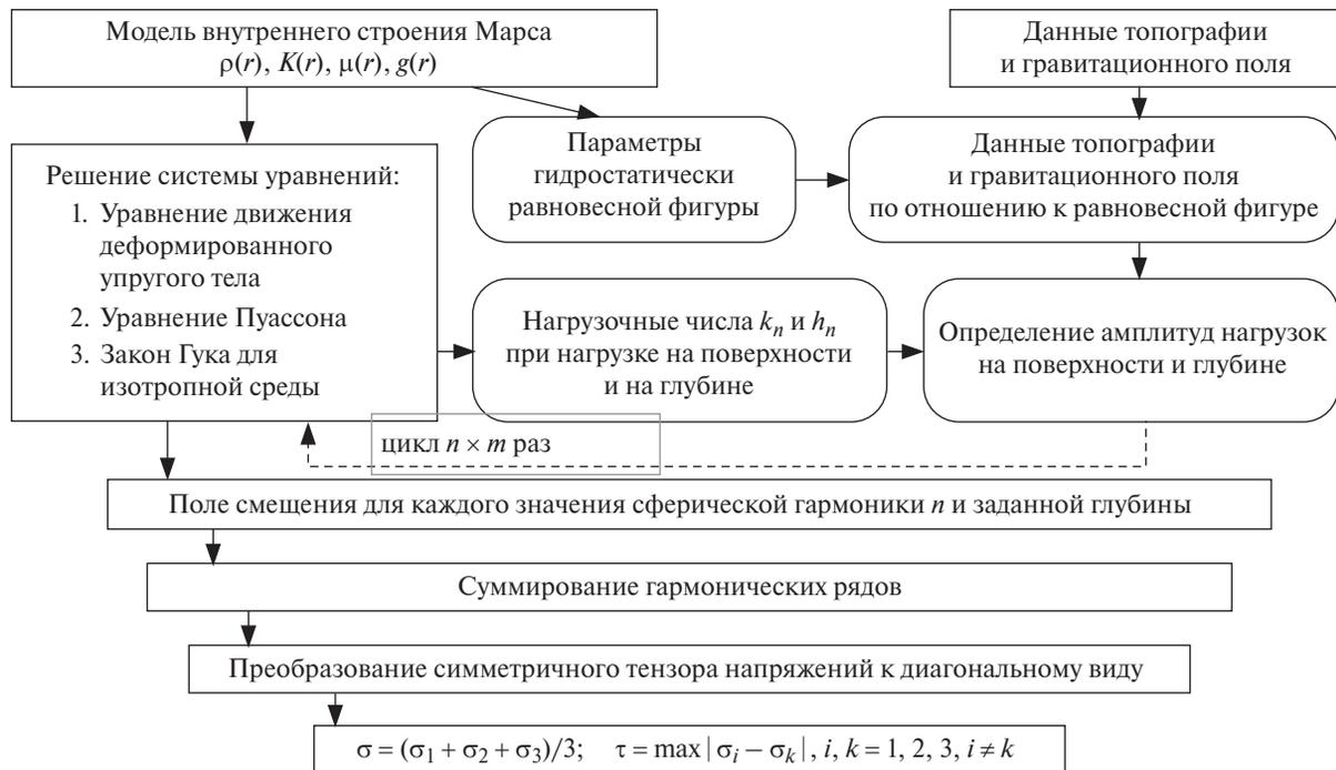
Рис. П1. Блок-схема расчета напряжений в недрах Марса.
