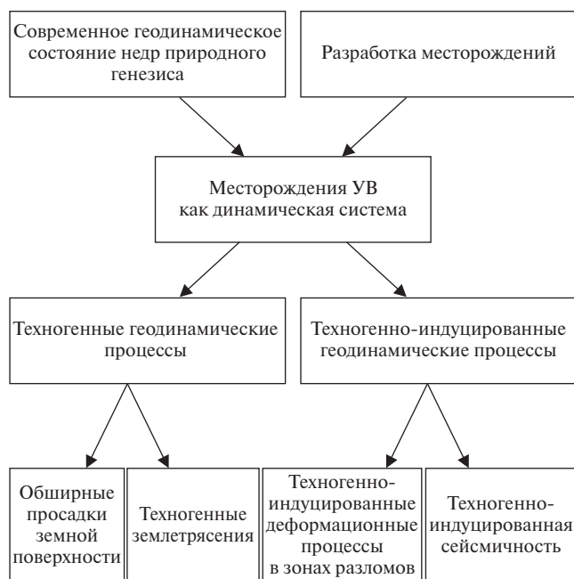
Рис. 6. Схема формирования геодинамических последствий разработки месторождений нефти и газа.
