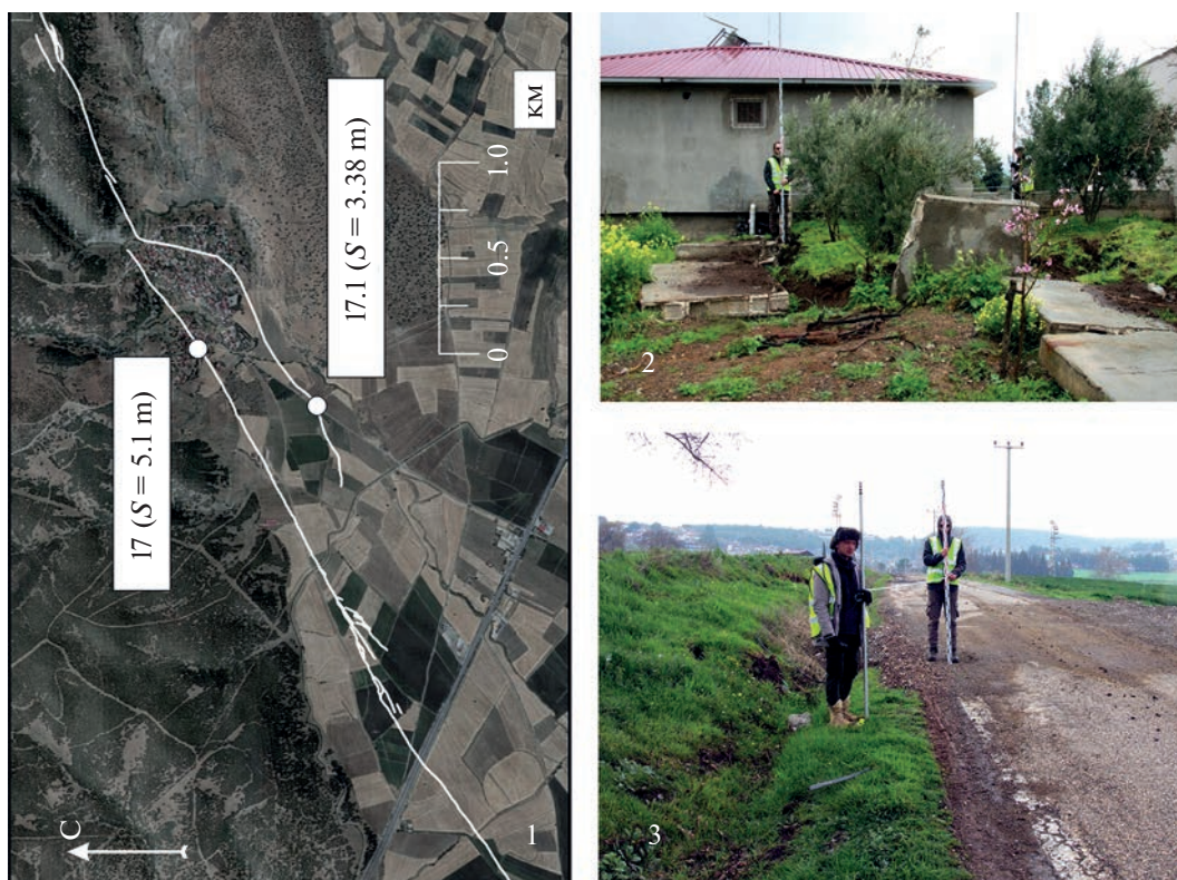
Рис. 7. Максимальные левосдвиговые сейсмогенные смещения по EAFZ севернее эпицентра главного толчка Восточно-Анатолийского землетрясения (т. 17 на рис. 5): 1 — карта сейсморазрывов 06.02.2023 г. с пунктами установленных сдвиговых смещений; 2 — левое смещение усадьбы конструкции на 5.1 м; 3 — левое смещение дорожного полотна на 3.38 м.
