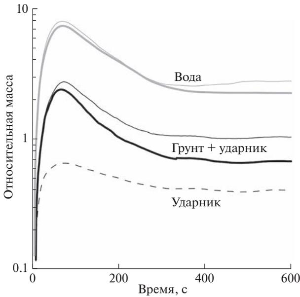
**Рис. 3.** Зависимости от времени массы воды (серые кривые), ударника (пунктир) и суммарной массы грунта и ударника (черные кривые) в атмосфере на высотах более 16 км. Массы измеряются в массах падающего астероида. Толстые кривые соответствуют прямому интегрированию распределений плотности, тонкие получены с помощью маркеров.
