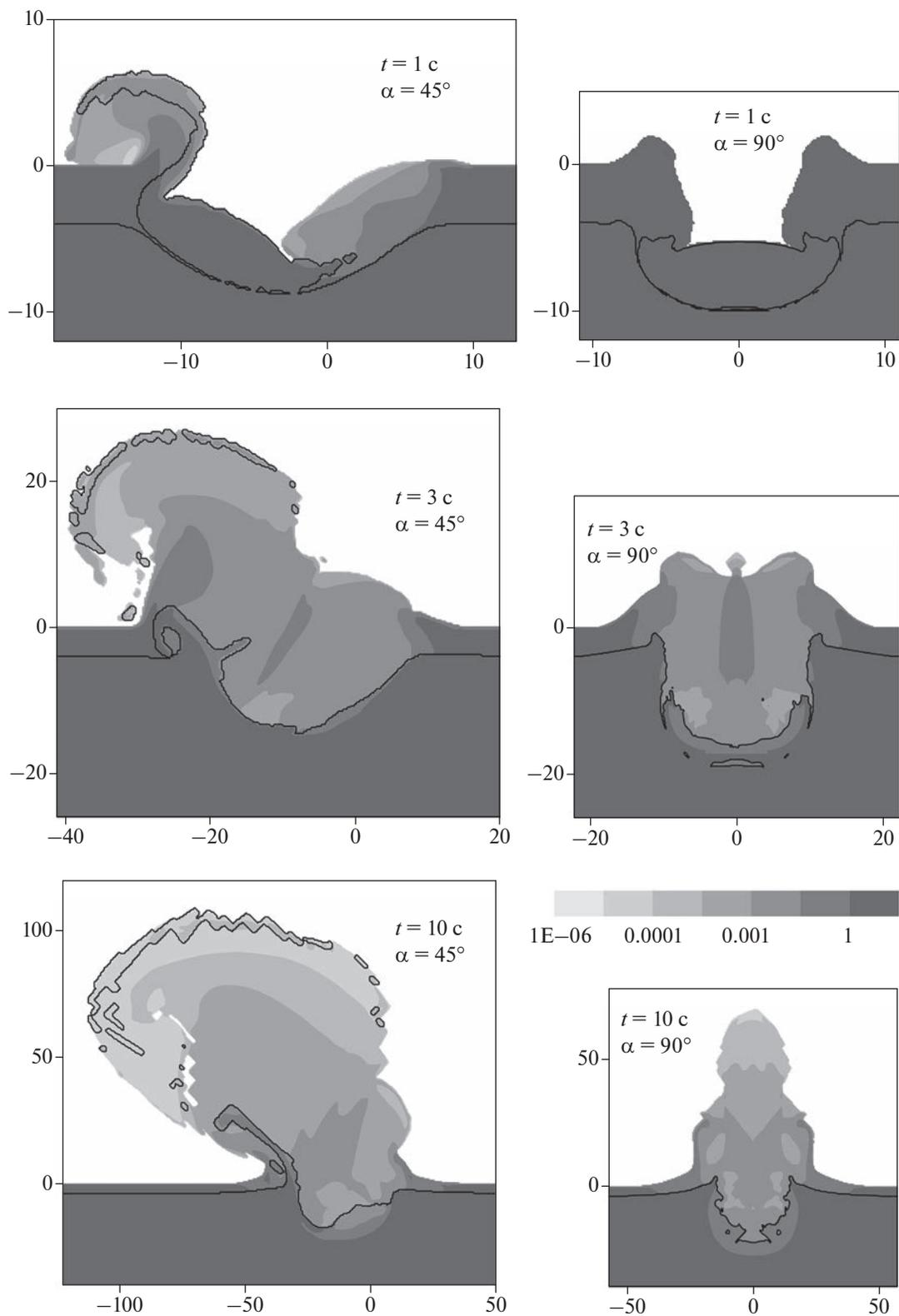
**Рис. 1.** Распределения плотности воды и вещества ударника и грунта в  $\text{г/см}^3$  через 1, 3 и 10 с после падения десятикилометрового астероида со скоростью 20 км/с под углом  $45^\circ$  (слева) и вертикально (справа) в океан глубиной 4 км. Черная линия показывает границу между водой и веществом ударника и мишени. Все расстояния измерены в километрах.
