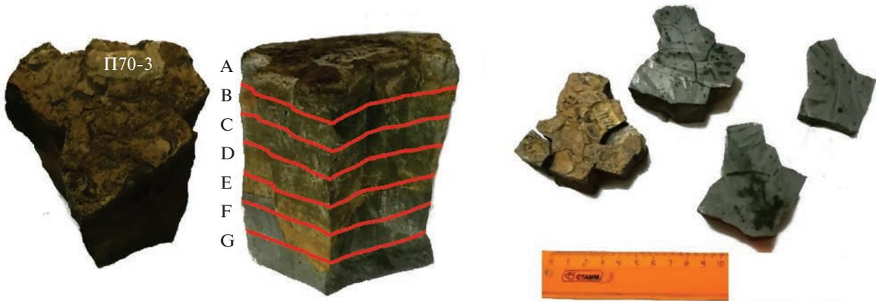
Рис. 1. Общий вид и предварительно распиленный на 7 слоев кусок пиллоу-базальта П70-3.
