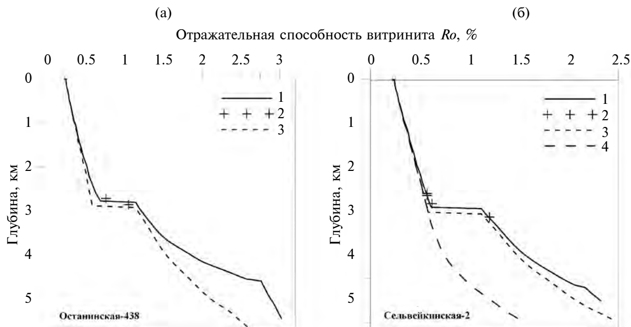
Рис. 9. Распределения ОСВ в современных осадочных разрезах скв. Останинская-438 (а) и Сельвейкинская-2 (рис. 16). 1 — рассчитанное распределение ОСВ; 2 — измеренные значения ОСВ; 3 — ОСВ, рассчитанная без гидротерм в плейстоцене; 4 на рис. (б) — ОСВ, рассчитанная без тепловых эффектов гидротерм в плейстоцене и интрузии в юре.
