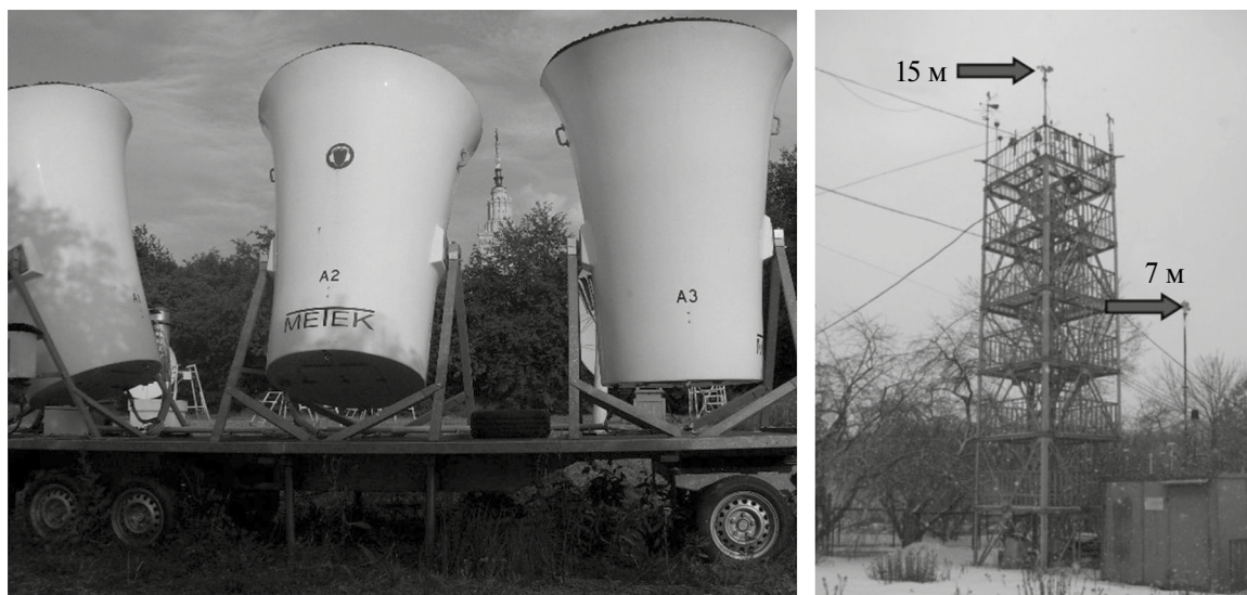
Рис. 1. Антенная система доплеровского содара MODOS (слева) и анемометрическая вышка с датчиками ветра (справа) в Метеорологической обсерватории МГУ. Стрелками показаны анемометры на двух высотах.
