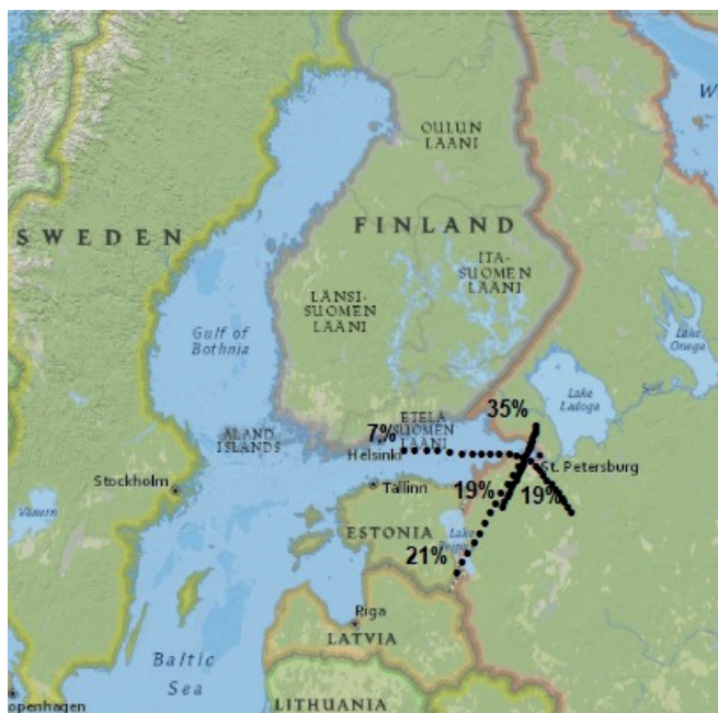
Рис. 5. Кластеры обратных траекторий движения воздушных масс по данным расчета модели HYSPLIT для дней с высокими значениями \sigma_{sp}(550) (более 70) по измерениям нефелометра.
