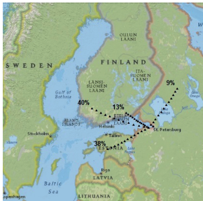
Рис. 4. Кластеры обратных траекторий движения воздушных масс по данным расчета модели HYSPLIT для дней с минимальными значениями \alpha_{s\ 450}(700) (менее 1) по измерениям нефелометра.
