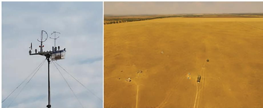
**Рис. 5.** Вид полигона и расположение приборов в Цимлянске 2021 г. Анемометр устанавливался на расстоянии 1 метр от циркулиметра. Измерения проводились: на высотах 1.75 и 30 м в 2021 г.; на высоте 30 м в 2022 г.
