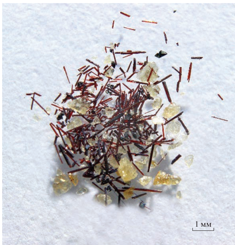
Рис. 3. Собственные фазы Ln в поле кристаллизации гематита (оп. 4). Пластинчатые кристаллы — водный оксихлорид преимущественно легких и средних Ln, игловидные — оксигидроксид Fe и средних-тяжелых Ln, изометричные кристаллы ромбической формы — гематит.
