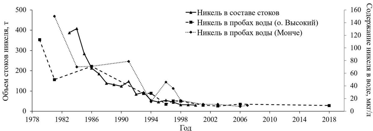
**Рис. 2.** Динамика поступления никеля в составе сточных вод и концентрация в воде в зонах отбора проб на озере Имандра (в заливе Монче и у о. Высокий).
