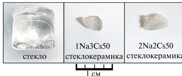
**Рис. 2.** Фото образцов стекла  $1\text{Na}3\text{Cs}50$  и стеклокерамических материалов составов  $1\text{Na}3\text{Cs}50$  и  $2\text{Na}2\text{Cs}50$ .
