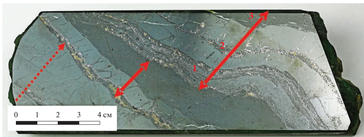
Фиг. 7. Горевское месторождение. Рудный ритм: 1 (ярко-серое) — рудные прослои, сложенные в основном галени- том, сфалеритом, меньше пирротинном, кварцем, карбонатом; 2 (зеленовато-серое) — прослои сидерита; 3 (темно-се- рое) — прослои углеродисто-хлорит-кварц-карбонатного сланца с вкраплениями ильменита. Красной стрелкой “вправо—влево” показан полный ритм, простой точечной стрелкой — часть ритма. В деформированном сидеритовом прослое хорошо видны трещины кливажа, частично, а местами — полностью заполненные регенерированными в про- цессе динамометаморфизма сульфидами (в основном галени- том — белые просечки).
