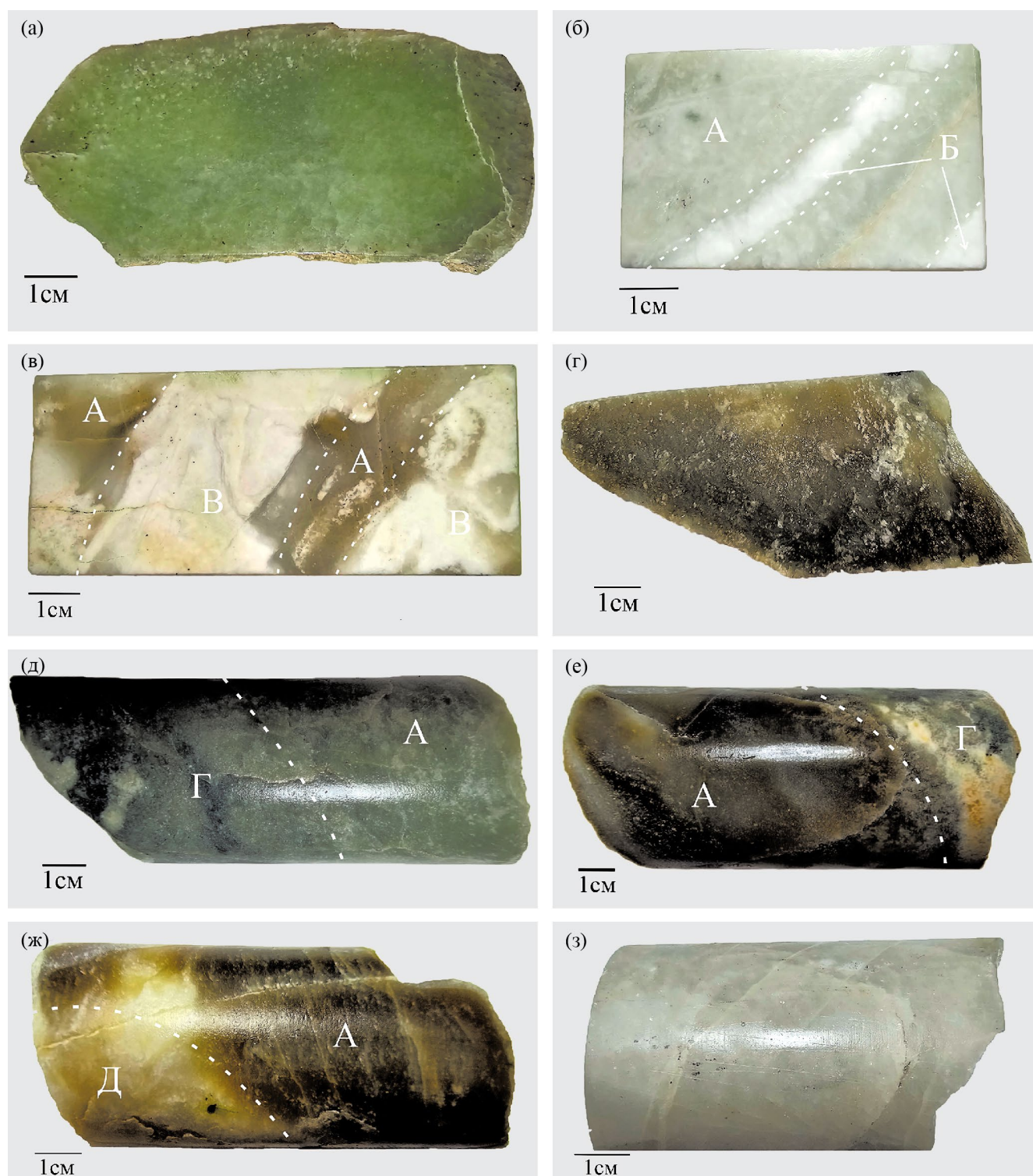
Фиг. 5. Цветовые вариации нефрита Воймаканского месторождения: а – салатный V1-14; б – светло-салатный (А) с обособлениями кальцит-тремолитового агрегата (Б) РК 5-4-1; в – диопсидит (В) с серо-салатным нефритом (А) КР 57-1-12; г – бурый (медовый) РК 3; д – контакт эпидот-тремолитового скарна (Г) со светло-зеленым нефритом (А) КР 5-3-1; е – контакт эпидот-тремолитового скарна (Г) с коричневым (медовым) нефритом (А) РК 3; ж – контакт кальцит-тремолитового скарна (Д) с коричневым (медовым) нефритом (А) РК 4; з – доломит КР 81-1-3.
