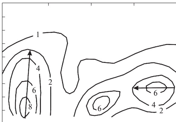
Фиг. 3. Схема Николаева для выделения сопряженных полюсов систем трещин по данным о числе полюсов трещин в единице площади. На прямоугольной диаграмме (по горизонтали отложен азимут простирания, а по вертикали угол погружения/восстания) показаны изолинии плотности полюсов трещин, стрелки показывают возможное положение на диаграмме второго максимума плотности, сопряженного с первым. Рисунок из работы (Николаев, 1991).
