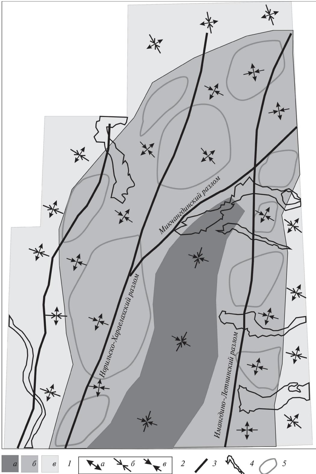
**Рис. 3.** Схема латеральной ориентации главных напряжений в консолидированной коре (нижнепермско–триасовой туфолаваовой толщи) Норильского района перед началом магматизма в конце пермского периода, полученная по результатам тектонофизического анализа разрывных структур.
