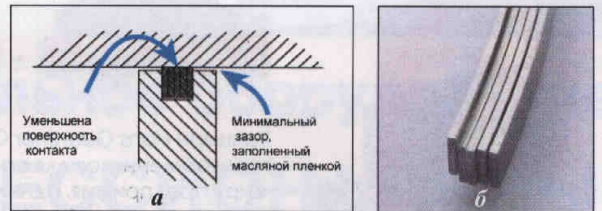
Рис. 5. Торцевое уплотнение: а – конструкция уплотнения; б – уплотняющие пластины
