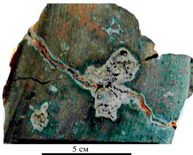
Рис. 2. Спил обр. B5–6–90ТР. Хорошо видны трещина и выполненные минералами пустоты.
