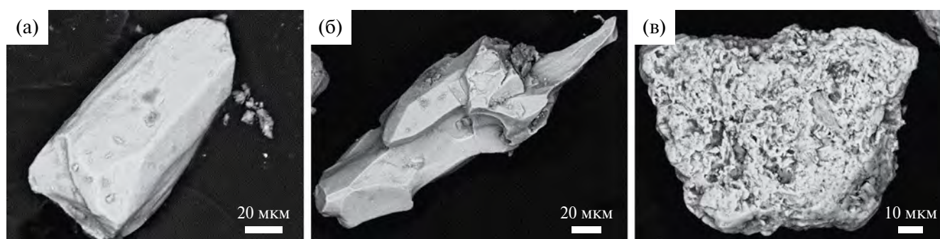
Рис. 3. Рутил отобранной минералого-технологической пробы Итмановской россыпи (BSE-изображения). а – кристаллы и их обломки со слегка округленными ребрами; б – остроугольные неокатанные обломки; в – полуокатанные зерна с неровной поверхностью, вероятно, связанные с развитием рутила по ильмениту в титаномagnetите.
