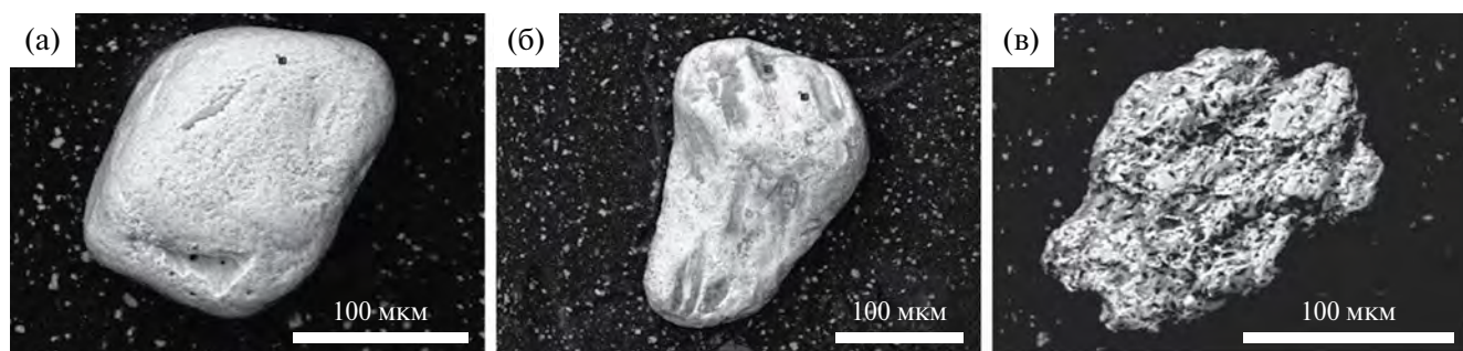
Рис. 5. Лейкоксен отобранной минералого-технологической пробы Итмановской россыпи (BSE-изображения). а — хорошо окатанные зерна глубоко измененного ильменита; б, в — зерна с реликтами ильменита.
