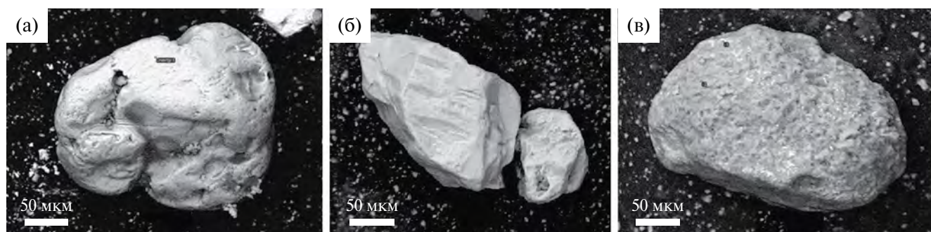
Рис. 6. Гематит отобранной минералого-технологической пробы Итмановской россыпи (BSE-изображения). а — массивные зерна гематита хорошей окатанности; б — плохоокатанные массивные зерна; в — кавернозные зерна с примазками гидроокислов.
