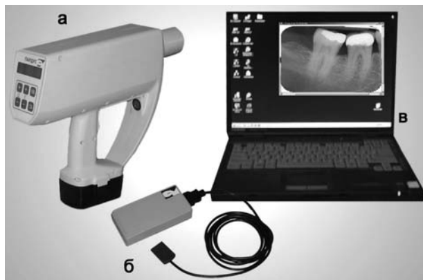
Рис. 1. Внешний вид рентгенодиагностического комплекса «ПАРДУС-Стома» (а – портативный рентгеновский аппарат «ПАРДУС-Р», б – рентгеночувствительная ПЗС-матрица, в – ноутбук)
