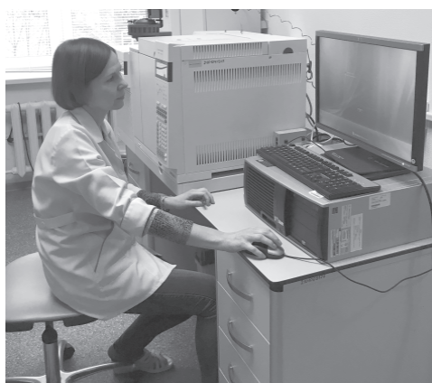
Рис. 1. Руководитель испытательной лаборатории проводит анализ на хроматографе газовом модели Agilent 7890A с масс-селективным детектором, типа тройной квадруполь, модель Agilent 7000
