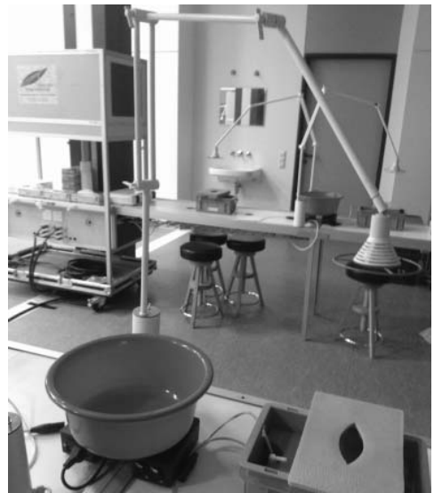
Рис. 1. Рабочее место для выполнения вмешательств на нативных артериях животных (корпус макета с подведенной к нему системой трубок подачи жидкости)
