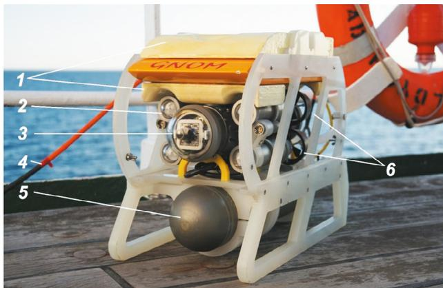
**Рис. 5.** ТНПА “ГНОМСупер” с гамма-спектрометром РЭМ-35-2: 1 – дополнительные блоки плавучести; 2 – правый верхний светильник; 3 – передняя основная видеокамера; 4 – кабель-трос; 5 – гамма-спектрометр; 6 – блок маршевых двигателей левого борта.
