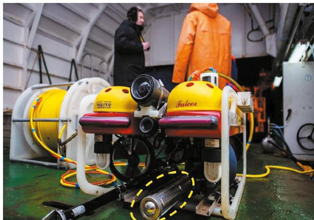
Рис. 7. ТНПА «Фалькон»: пунктирной линией обведен гамма-спектрометр РЭМ-4-50.
