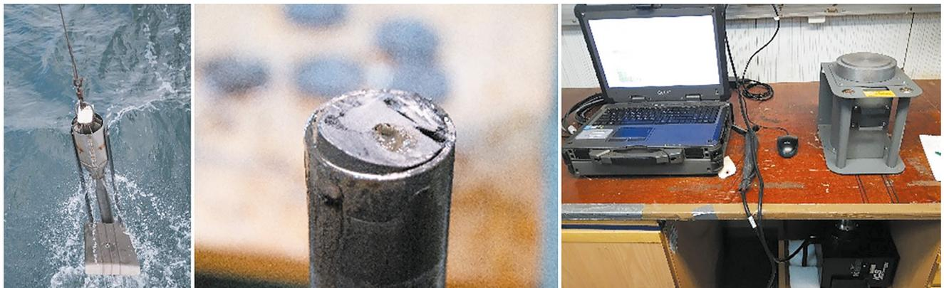
Рис. 11. Отбор и измерение радиоактивности проб донного грунта: а) трубчатый гравитационный отборник “трубка Неймисто»; б) срез керна в процессе послойного разделения; в) спектрометрический комплекс СКС-07П-Г5 “Кондор” на основе полупроводникового детектора (справа).
