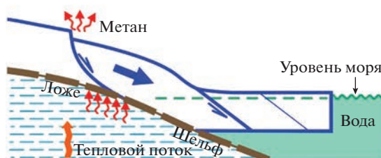
Рис. 5. Схема различных стадий и режимов движения покровно-шельфовых ледников в западной Антарктиде.
