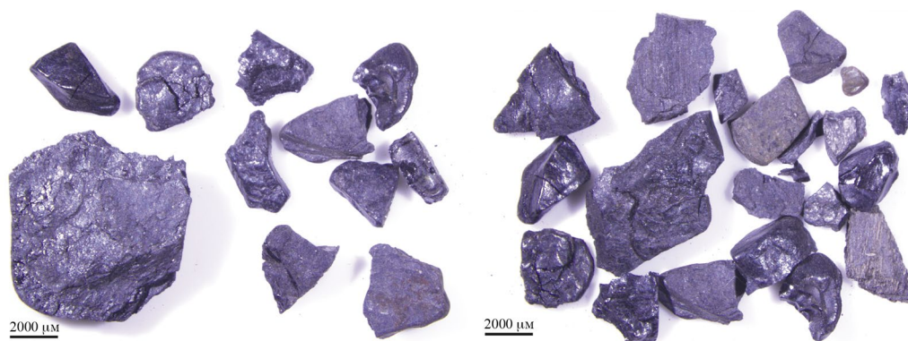
Рис. 5. Микрофотографии углеподобных частиц с горизонта 3447 см скважины 1D-14.
