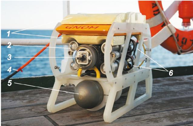
**Рис. 5.** ТНПА “ГНОМСупер” с гамма-спектрометром РЭМ-35-2: 1 – дополнительные блоки плавучести; 2 – правый верхний светильник; 3 – передняя основная видеокамера; 4 – кабель-трос; 5 – гамма-спектрометр; 6 – блок маршевых двигателей левого борта.
