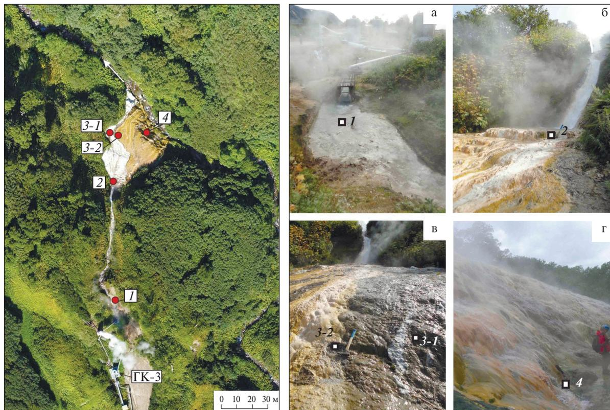
**Рис. 2.** Схема опробования минеральных отложений на скважине ГК-3.
