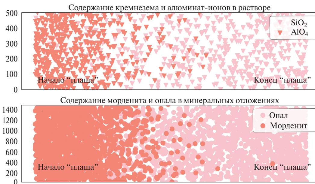
**Рис. 10.** Схема зональности по простиранию минеральных отложений скважин Паужетского геотермального месторождения: от цеолитового начала до опалового конца.
