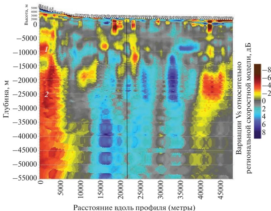
**Рис. 5.** Глубинный разрез вдоль профиля Эльбрус–Тырныуз на основе данных микросейсмического зондирования. Цветовая шкала показывает степень отклонения (в децибелах) скоростей поперечных сейсмических волн от средней региональной модели [Milyukov et al., 2018].
