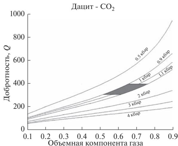
**Рис. 4.** Модель зависимости добротности резонансных мод магматической камеры от объемной составляющей газа в магматическом флюиде для различных значений давления [Милюков, 2006]. Темным цветом выделена область значений физических параметров новой магматической камеры.
