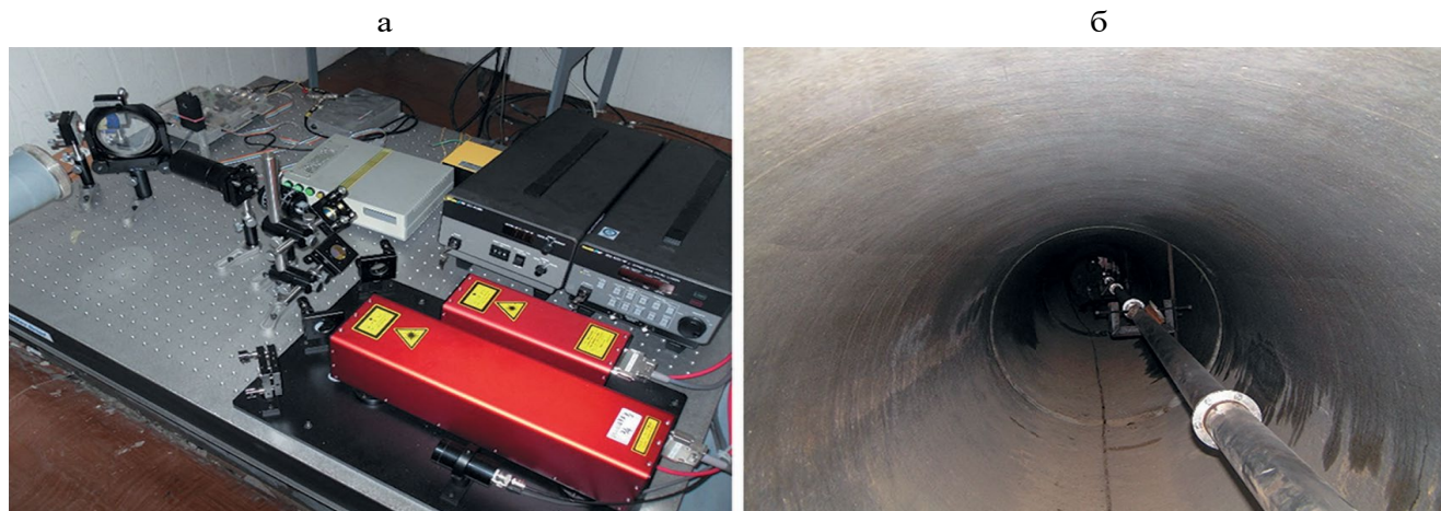
Рис. 1. Горизонтальный лазерный деформограф с длиной измерительного плеча 52.5 м.
