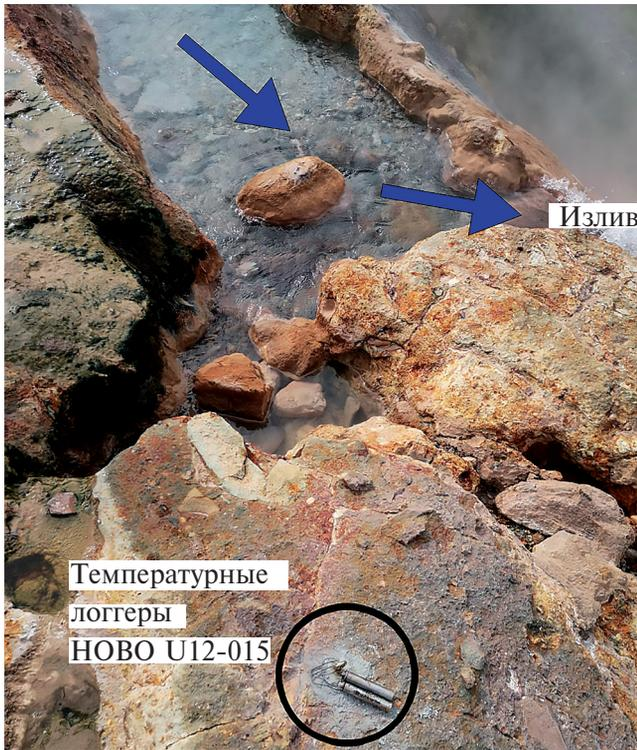
**Рис. 4.** Схема установки логгеров на изливе гейзера Грот. Место установки логгеров на фотографии показано кружком, стрелки показывают направление истечения воды из гейзера Грот.
