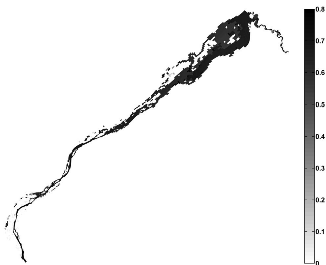
Рис. 2. Расчетная толщина (м) льда на Новосибирском водохранилище 7 апреля 1981 г.
