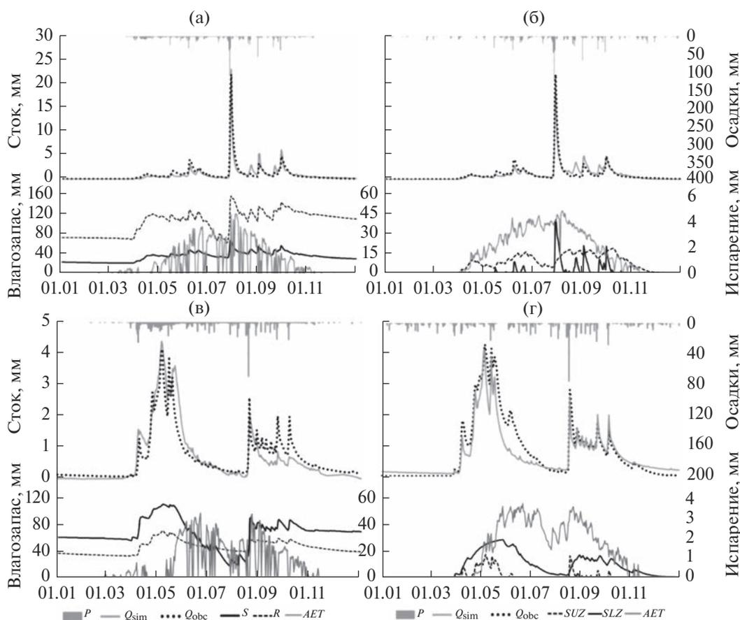
**Рис. 2.** Динамика основных компонентов водного баланса моделей GR4J (а, в) и HBV (б, г) на примере Павловка—Антоновка (а, б) в 1989 г. (исторический паводок) и Каменка—Каменка (в, г) в 1979 г. (низкий сток):  $P$  — осадки,  $Q_{obs}$  — измеренный расход,  $Q_{sim}$  — моделированный расход,  $AET$  — модельное испарение,  $S$  и  $R$  — емкости модели GR4J,  $SUZ$  и  $SLZ$  — емкости модели HBV.
