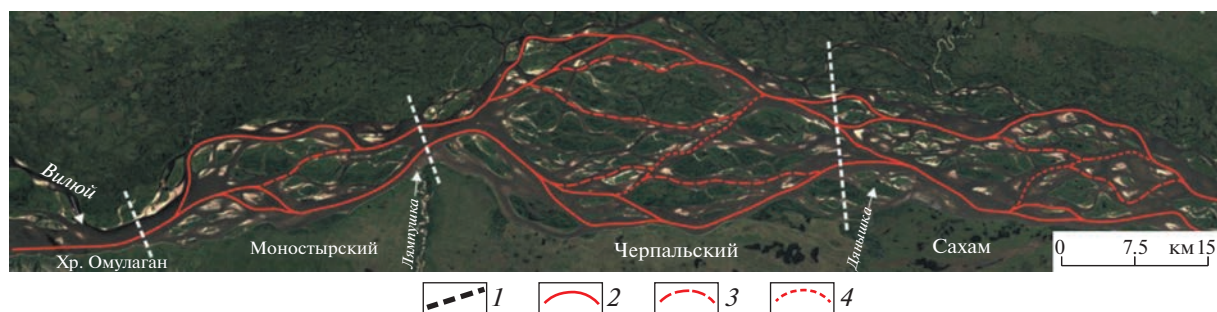
Рис. 1. Общая схема (космоснимок) разветвленного русла нижней Лены ниже устья Вилюя. 1 — границы звеньев разветвлений; 2 — положение стрежневой зоны потока в левом и правом основных рукавах и во вторичных разветвлениях основных рукавов; 3 — то же в субпараллельных рукавах; 4 — то же в диагональных рукавах.
