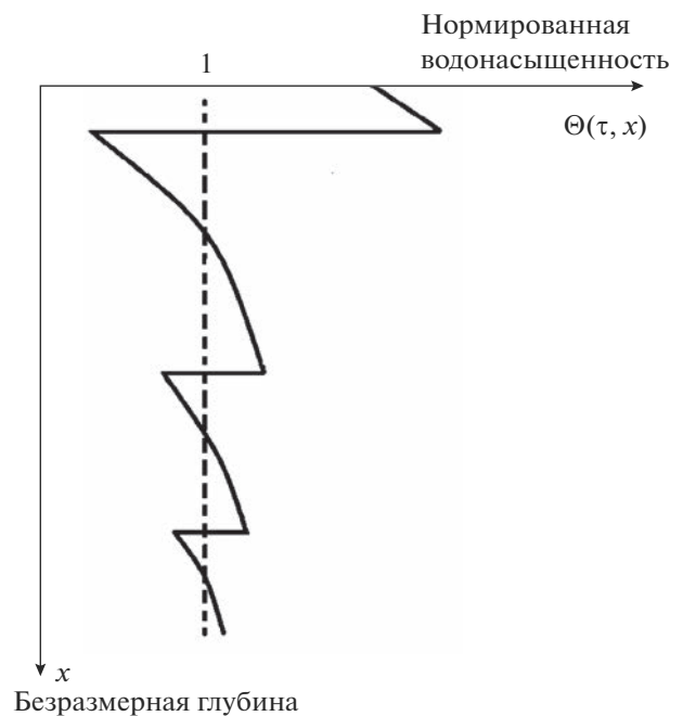
Рис. 2. Качественный вид зависимости профиля нормированной водонасыщенности \Theta(\tau, x) от глубины x в задаче о бескапиллярной инфильтрации.
