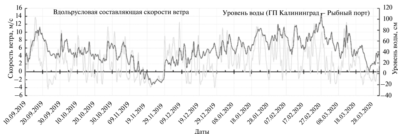
Рис. 4. Временной ход вдоль русловой составляющей скорости ветра (по данным МГ-1 Балтийск) и уровня воды (ГП Калининград – Рыбный порт) в период 10.09.2019–27.03.2020. Представлены скользящие средние с 15-часовым окном осреднения (5 сроков). Положительное значение вдольрусловой составляющей скорости ветра соответствует направлению вверх по течению. Уровень воды представлен относительно условного нуля.
