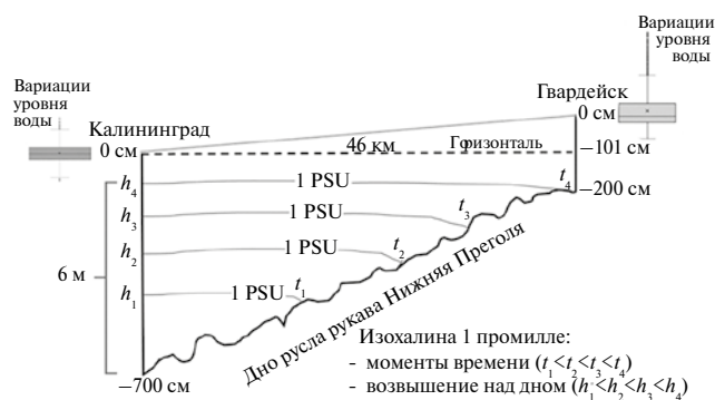
Рис. 9. Схема интрузионного проникновения солоноватой воды на участке р. Преголи от г. Калининграда до г. Гвардейск (расстояние от контрольной точки измерений — 46 км). Условно показаны положения изохалины 1 PSU (имеет небольшой наклон в сторону Гвардейска) в последовательные моменты времени по мере увеличения толщины солоностной интрузии в Калининграде. Пределы вариаций уровня воды в Калининграде и Гвардейске показаны в виде диаграмм размаха с указанием среднего, медиан и квартилей.
