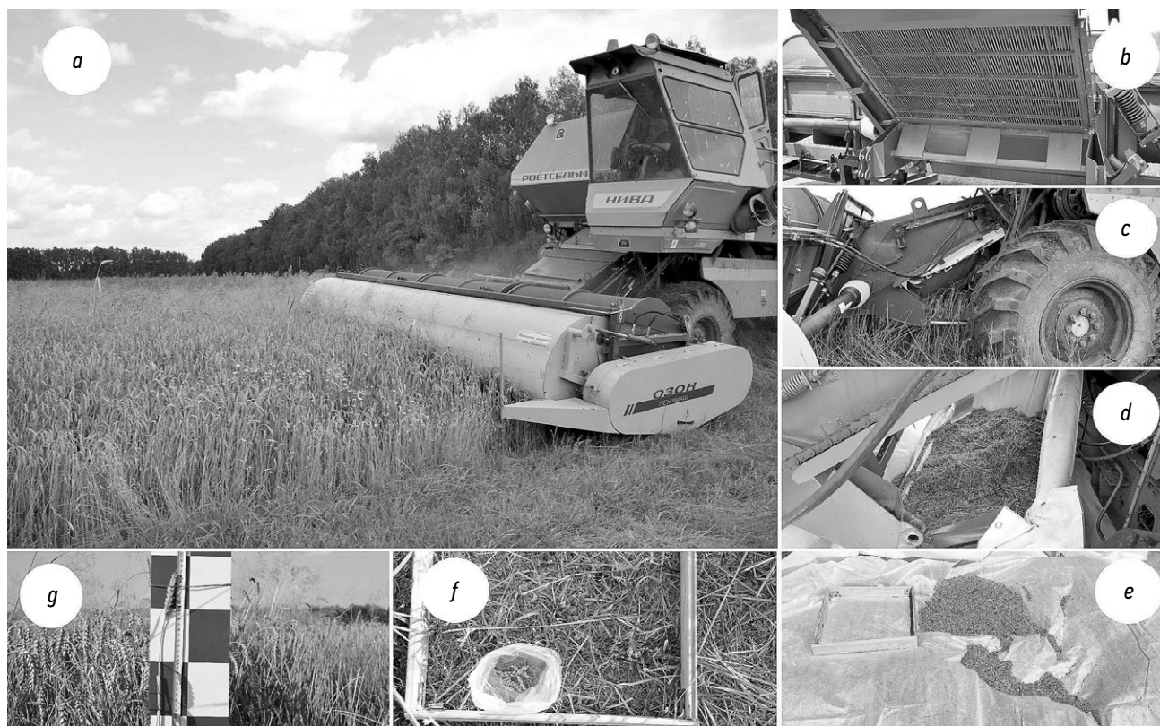
Рис. 2. Материалы и методика проведения полевых исследований: а) общий вид зерноуборочного комбайна; б) решетчатое днище наклонной камеры; в) мягкий контейнер; д) мягкий контейнер с очесанным зерновым ворохом; е) бункерное зерно; ф) определение потерь за комбайном; г) определение полеглости растений.
