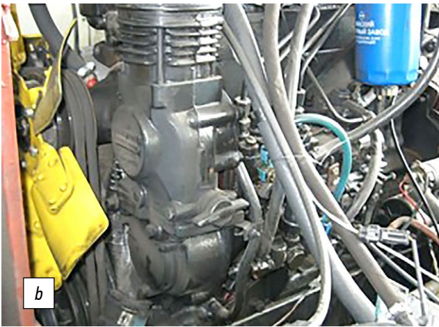
Рис. 1. Общий вид используемого оборудования и приборов: а – пульт управления дизелем; б – дизель Д-245 на стенде. Fig 1. General view of the equipment and devices used: а – control panel of a diesel engine; б – The D-245 diesel engine mounted on the test bench.
