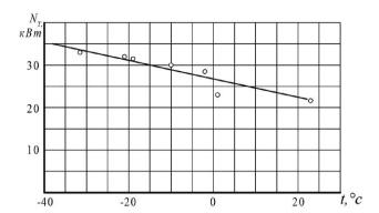
**Рис. 5.** Зависимость мощности турбокомпрессора ТКР-11H-1 при 100%-ной загрузке двигателя СМД-62  $n_{\rm дв}=2100~{\rm MuH^{-1}}$  от температуры ОС.
