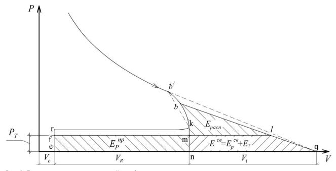
Рис. 1. Диаграмма эксергии, используемой в турбокомпрессоре двигателя.
