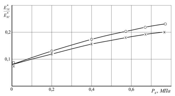
**Рис. 3.** Зависимость коэффициента использования эксергии выпускных газов двигателя СМД-62 в турбокомпрессоре ТКР-11H-1 по нагрузочной характеристике при  $n_{\rm дB} = 2100$  мин<sup>-1</sup> -x-x-x- -  $(t_{oc} = +24^{o}\,C)$ ; - o - o - o - o - o - o -  $(t_{oc} = -33^{o}\,C)$ .
