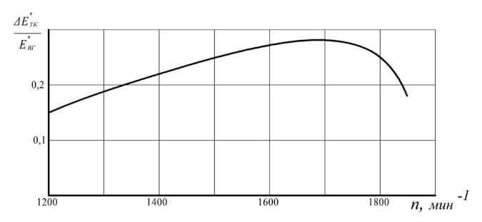
**Рис. 2.** Эксергетический коэффициент использования эксергии выпускных газов в турбокомпрессоре ТКР-8,5 при работе двигателя Д-440 на внешней скоростной характеристике.
