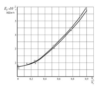
**Рис. 4.** Зависимость максимальной эксергии выпускных газов перед турбокомпрессором от степени загрузки двигателя СМД-62  $n_{\rm дB}=2100~{\rm Muh}^{-1}$  -x-x-x- -  $(t_{oc}=+24^oC)$ ; - 0 - 0 - 0 - 0 -  $(t_{oc}=-33^oC)$ .
