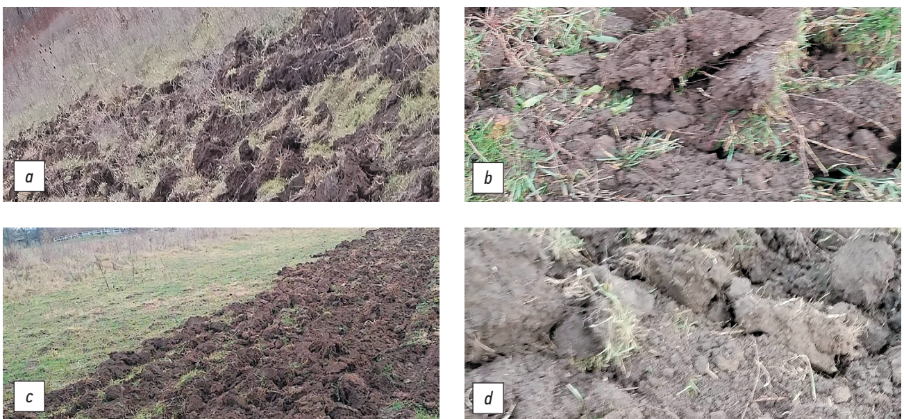
Рис. 4. Внешний вид почвы, обработанной под разными углами атаки дисков: a ) угол атаки 5°; b ) угол атаки 15°; c ) угол атаки 30°; d ) угол атаки 45°. Fig. 4. Appearance of the soil cultivated with various disk attack angles: a ) the attack angle 5°; b ) the attack angle 15°; c ) the attack angle 30°; d ) the attack angle 45°.
