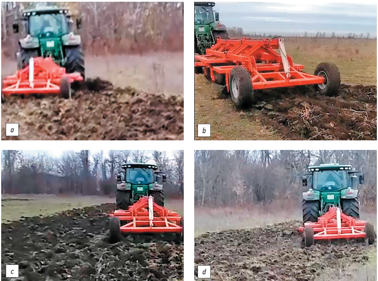
Рис. 3. Диско-чизельная борона при работе с разными углами атаки дисков: a – 45°; b – 30°; c – 15°; d – 5°. Fig. 3. The disk-chisel harrow at operation with various disk attack angles: a – 45°; b – 30°; c – 15°; d – 5°.
