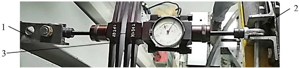
Рис. 4. Установка на стенд-гидропульсатор датчика боковой силы (вид сверху): 1 – крепление к вертикальной станине; 2 – крепление к опорной плите; 3 – динамометр Токаря.
