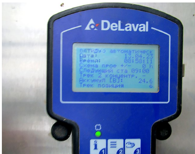
Рис. 2. Ручной терминал робота OptiDuo с показаниями технологического процесса.
