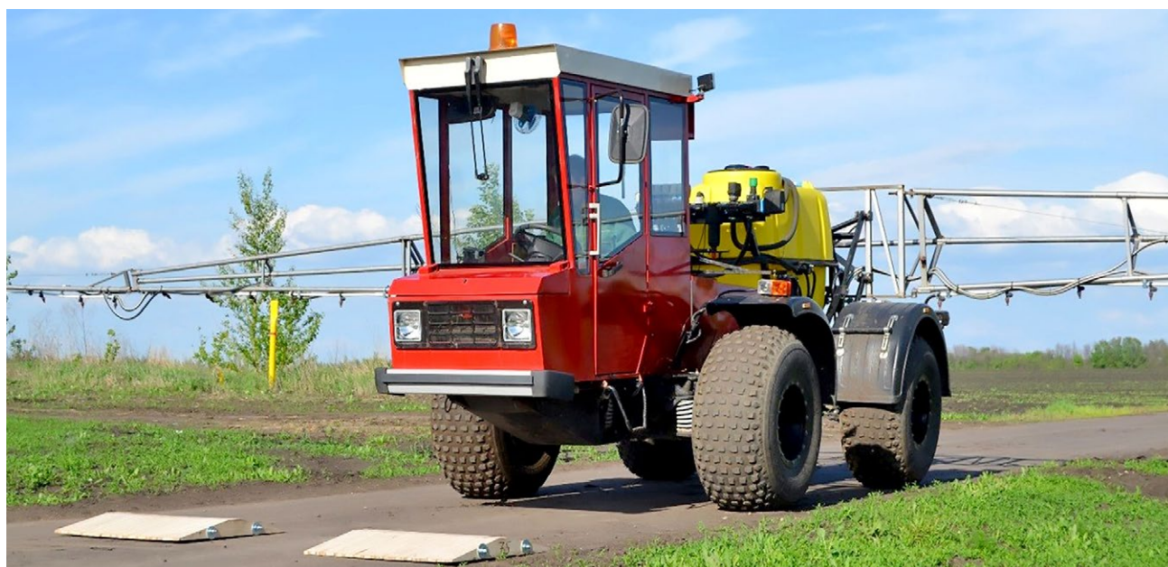
Рис. 1. Мобильное энергетическое средство на шинах сверхнизкого давления МЭС-600. Fig. 1. The MES-600 mobile power unit with ultra-low pressure tires.
