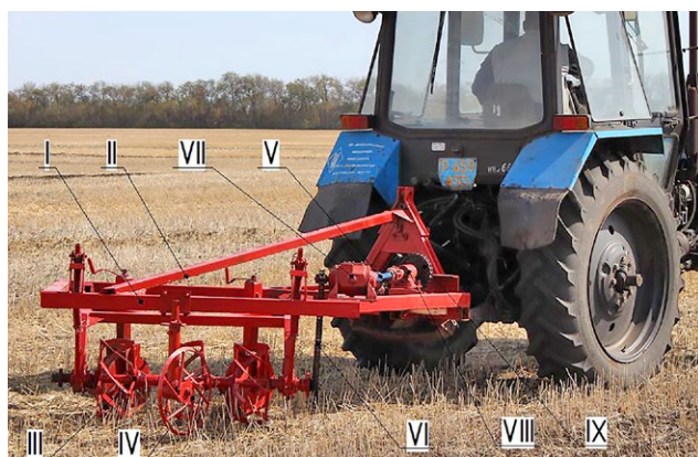
Рис. 1. Конструкция макетного образца орудия на предпосевной обработке почвы: I — несущая рама, II — откос, III — батарея ротационных рабочих органов, IV — опорное колесо, V — карданный вал, VI — цепь, VII — угловой редуктор, VIII — муфта предохранительная, IX — муфта обгонная.
