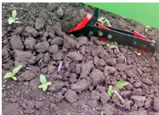
Рис. 5. Формирование опережающей трещины долотом нового рабочего органа парового культиватора.
