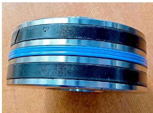
**Рис. 10.** Поршень гидроцилиндра вместе с уплотнениями.
