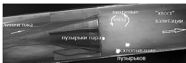
Рис. 5. Схема процесса кавитации. Fig. 5. Cavitation process diagram.
