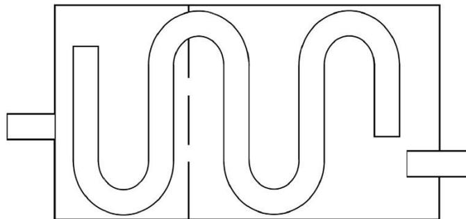
Рис. 5. Схема глушителя с длинным соединительным каналом.
