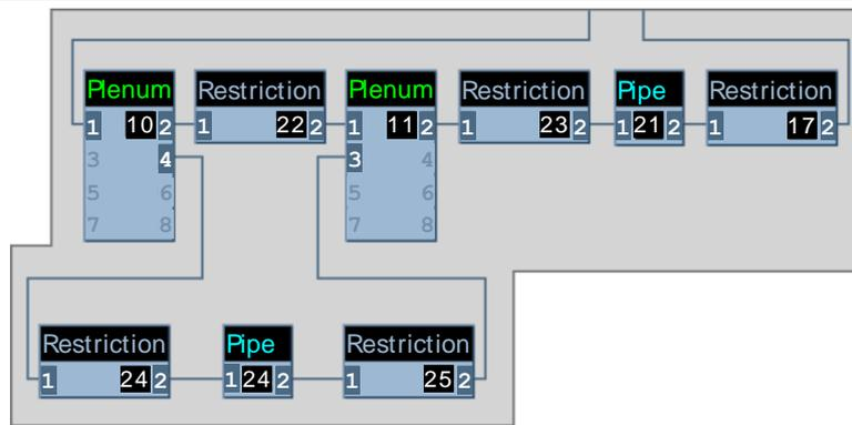
Рис. 6. Подмодель глушителя с каналом, соединяющим две камеры.
