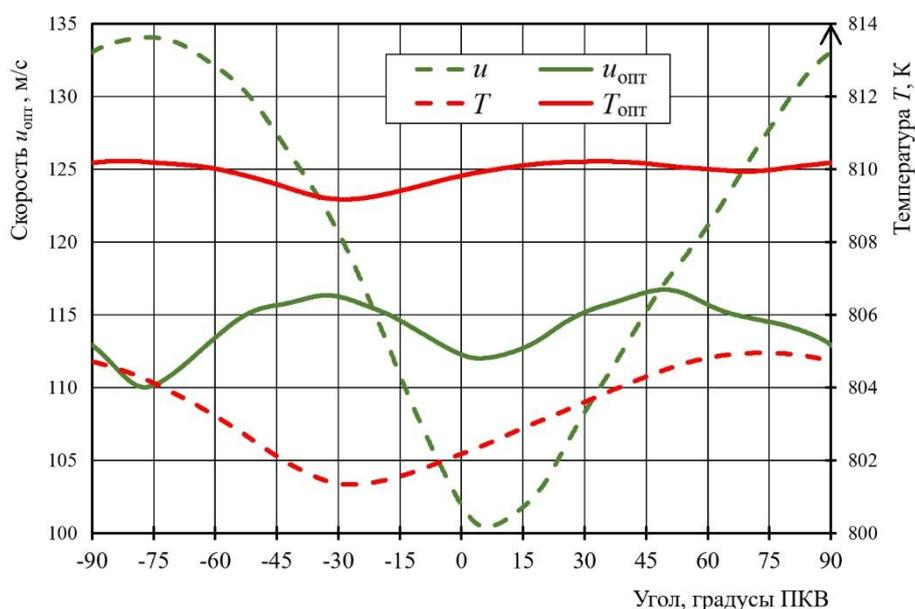
Рис. 7. Величины на срезе серийного (---) и оптимизированного (—) глушителя.
