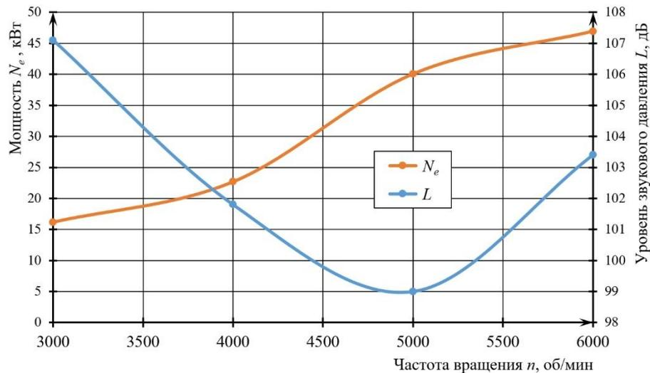
Рис. 8. Расчётные показатели для двигателя с оптимизированным глушителем.
