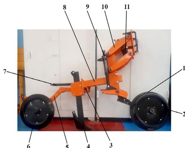
**Рис. 3.** Посевная секция: 1 — прорезной диск; 2 — опорное колесо; 3 — шарнир; 4 — анкерный сошник; 5 — кронштейн прикатывающего колеса; 6 — каток; 7 — регулировочная пружина прикатывающего колеса; 8 — грядиль; 9 — регулятор глубины; 10 — параллелограммный механизм; 11 — регулировочная пружина секции.
