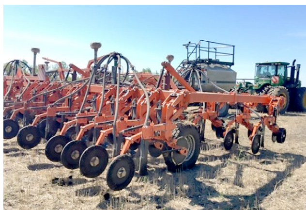
Рис. 6. Машинно-тракторный агрегат в составе с экспериментальным посевным комплексом ПК-12,7 при лабораторно-полевых экспериментах.
