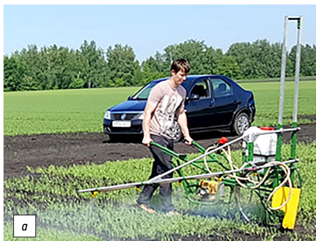
Рис. 1. Опытный образец одноопорного штангового мотоопрыскивателя (а) и устройство для измерения величины горизонтальных отклонений полевой штанги (б).
