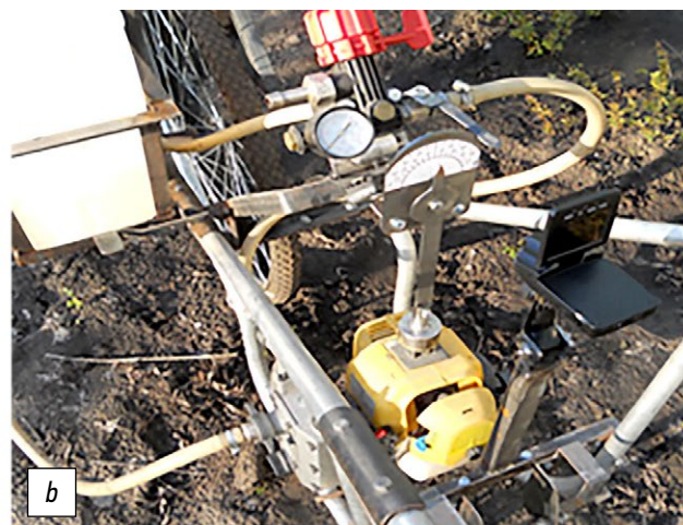
Рис. 1. Опытный образец одноопорного штангового мотоопрыскивателя (а) и устройство для измерения величины горизонтальных отклонений полевой штанги (б).
